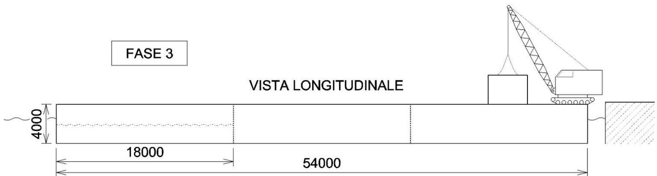
*Si chiede di calcolare la quantità di acqua da imbarcare per avere il pontone in assetto dritto.*
